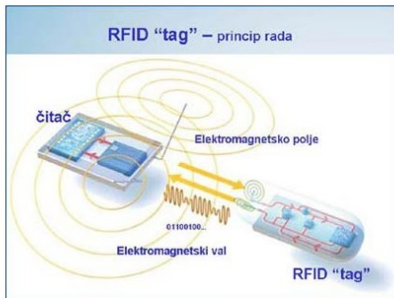
Slika 2. Način rada RFID-a
