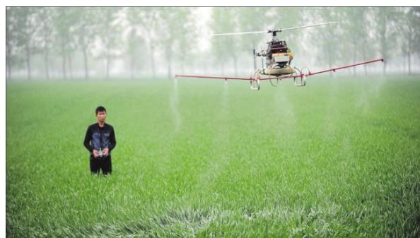
*Slika 3: Bespilotna letjelica kao zaprašivač*
