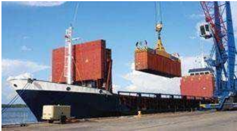
Slika 12: Lo – Lo brod, vertikalni ukrcaj
