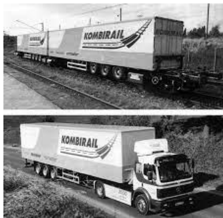
Slika 7: HUCKEPACK tehnologija B
