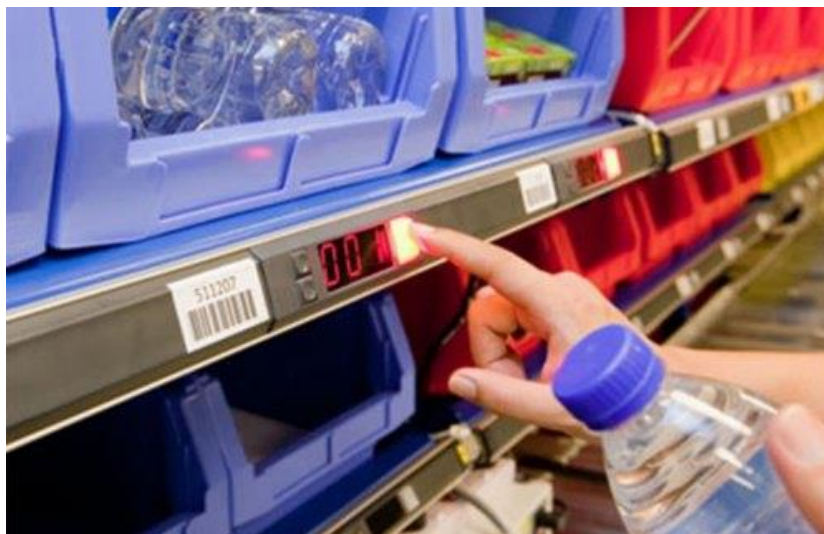
Slika 17: Svjetlom usmjereno komisioniranje (izvor: https://www.indiamart.com/proddetail/pick-to-light-system-21738811333.html )
