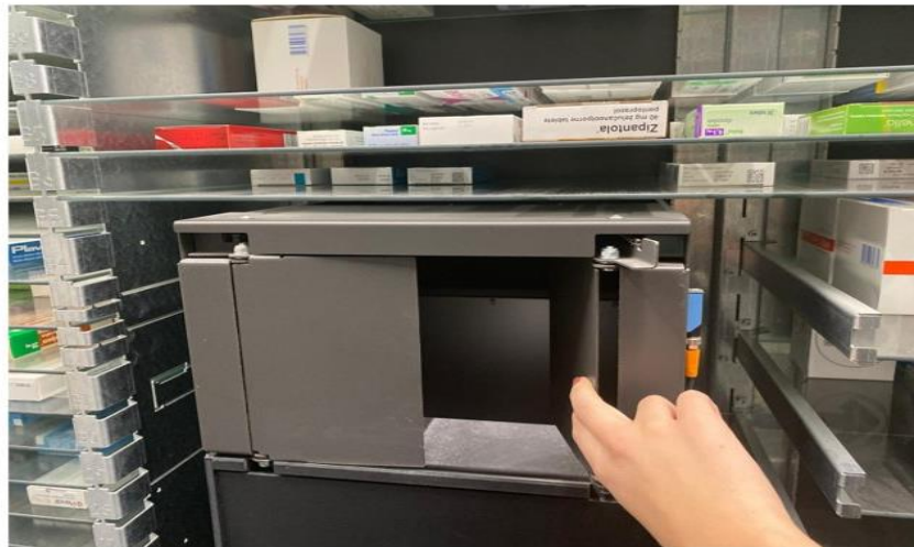
Slika 22: Otvor za odlaganje izuzetog proizvoda (izvor: vlastita izrada)
