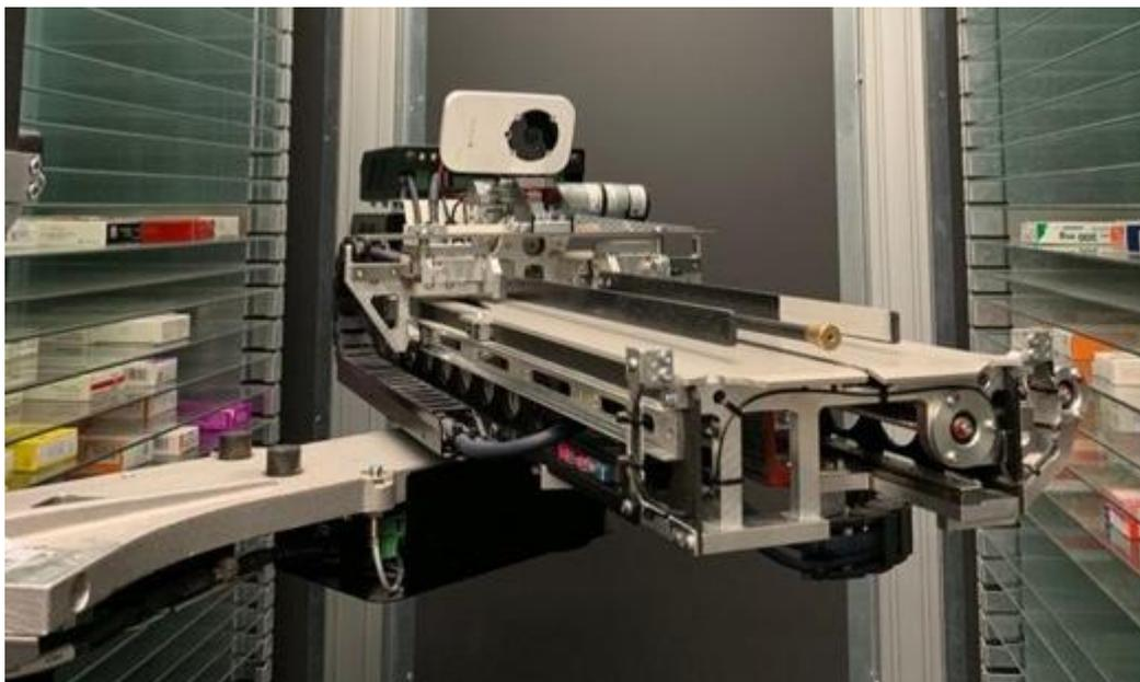
Slika 21: Robotska ruka Rowa Vmax (izvor: vlastita izrada)
