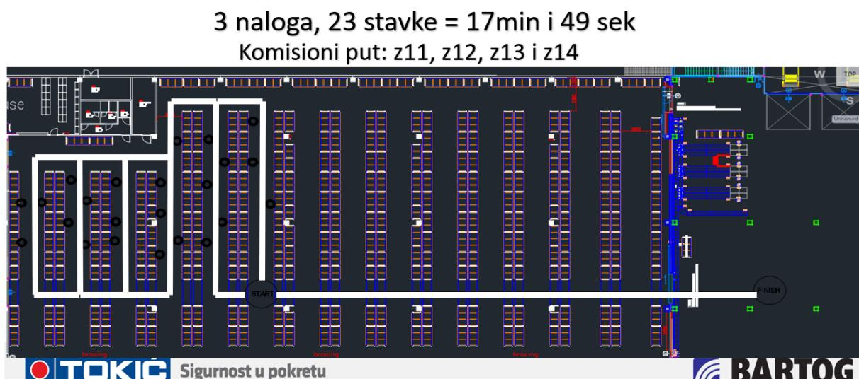
Slika 9. Komisoni put (stari princip – označeno bijelom linijom) Izvor: izrada Sandre Novak,
