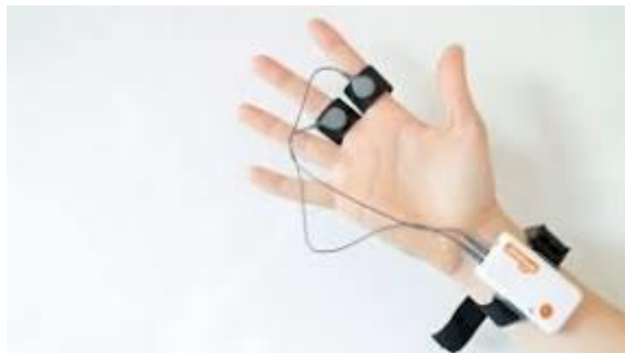
Slika 2 Primjena GSR uređaja. Izvor: Imotions.com (2023)
