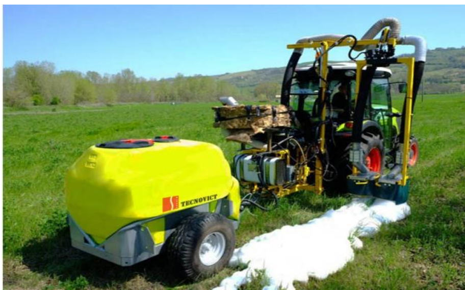
Slika 4. Ekološka kontrola korova zagrijanom pjenom
