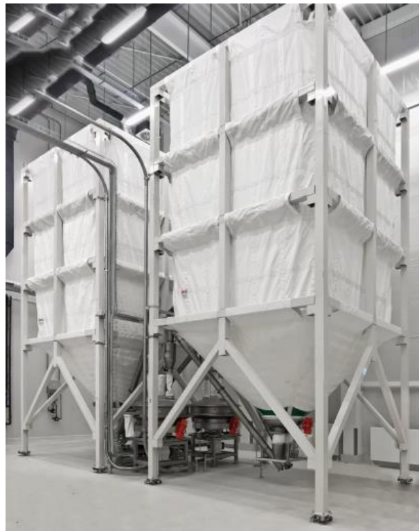
Slika 3 Cisterna-skladište sirovine (izvor: https://timzip.hr/skladistenje-i-doziranje-sipkih-sirovina/ ; pristupljeno: 28.6.2024.)
