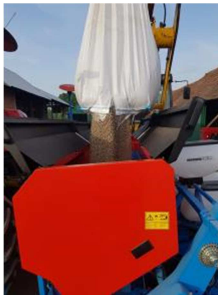
Slika 18. Utovar gnojiva Petrokemije d.d.iz velikih ( engl. big-bag ) vreća u raspršivače suvremenije opremljenih poljoprivrednika
