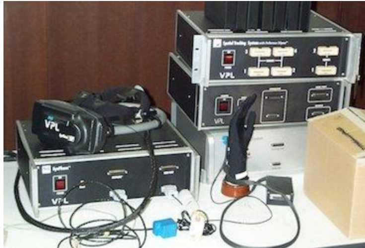
Slika 5: Dataglove i EyePhone
