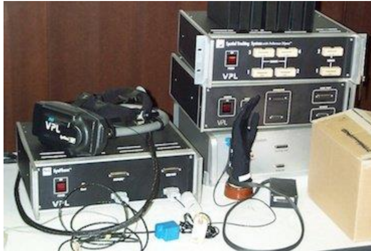
Slika 5: Dataglove i EyePhone
