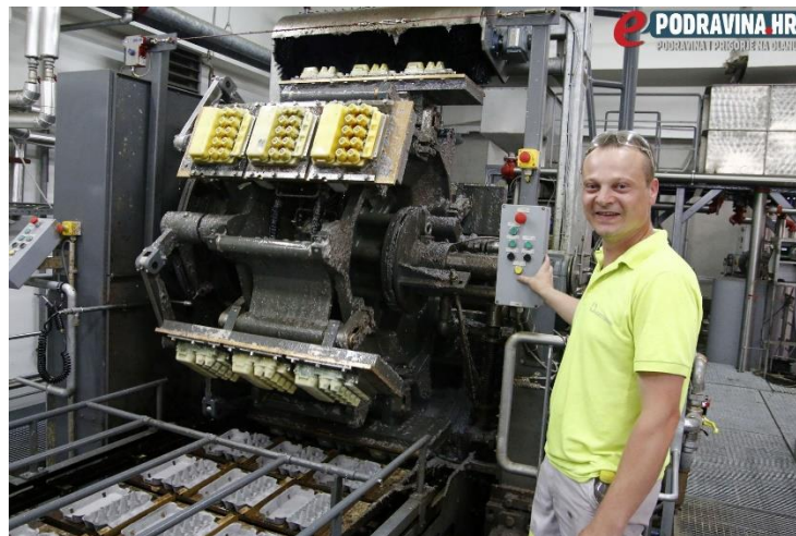
Slika 15. Stroj za kalupiranje u tvornici u Koprivnici
