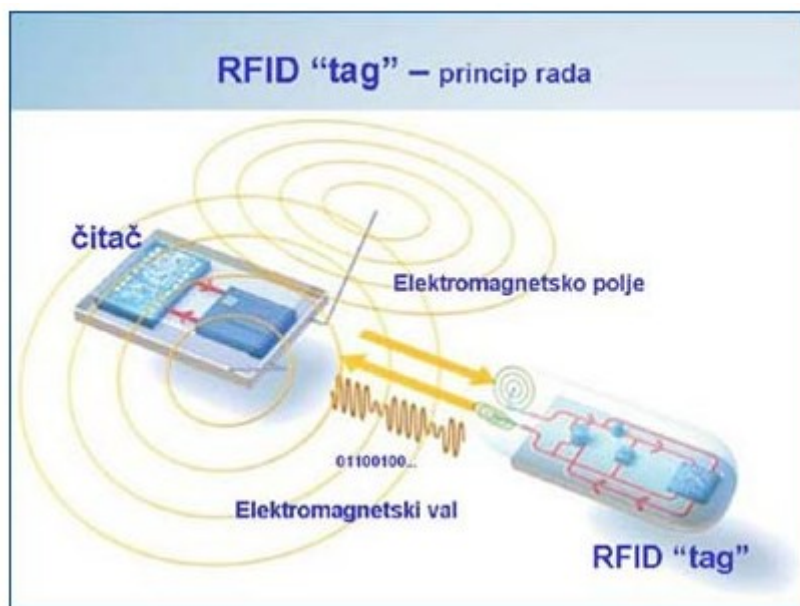
Slika 2. Način rada RFID-a
