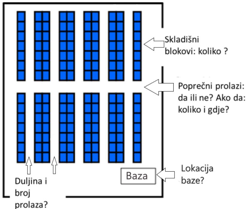
**Slika 11.** Tipične odluke vezane uz layout unutar skladišta i dizajn sustava za komisioniranje
