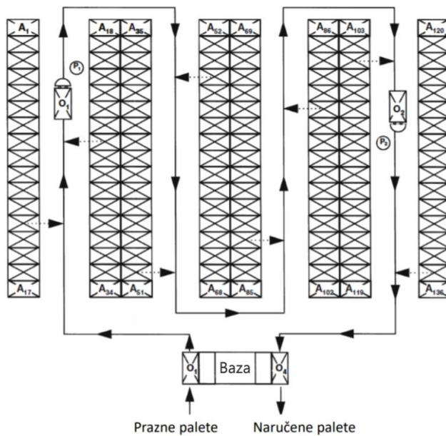
**Slika 3.** Uobičajeno komisioniranje sa statičnim artiklom po principu „čovjek robi“ (Izvor: Kotzab, H. & Gudehus, H. 2012)
