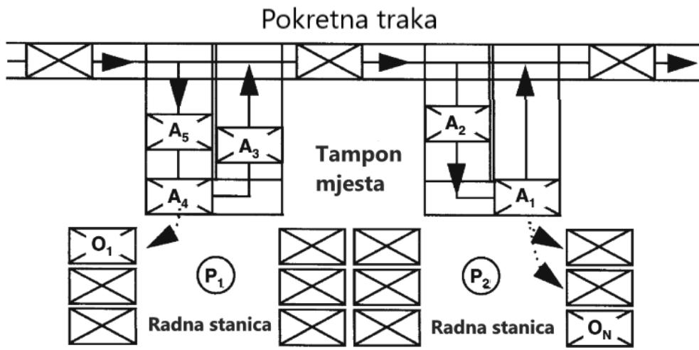
**Slika 4.** Statičko komisioniranje sa dinamičkom opskrbom artikala po principu „roba čovjeku“
