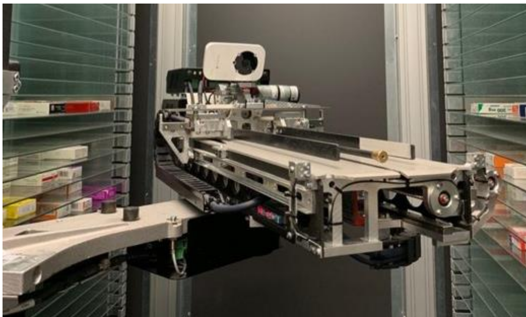
Slika 21: Robotska ruka Rowa Vmax (izvor: vlastita izrada)
