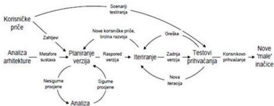
Slika 12. Životni ciklus projekta primjenom Ekstremnog programiranja
