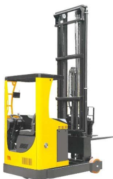
Slika 12. Električni regalni viličar s računalom
