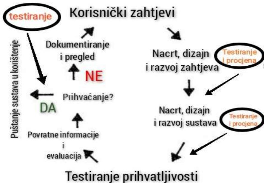
**Slika 3.** Proces agilne metode testiranja sustava
