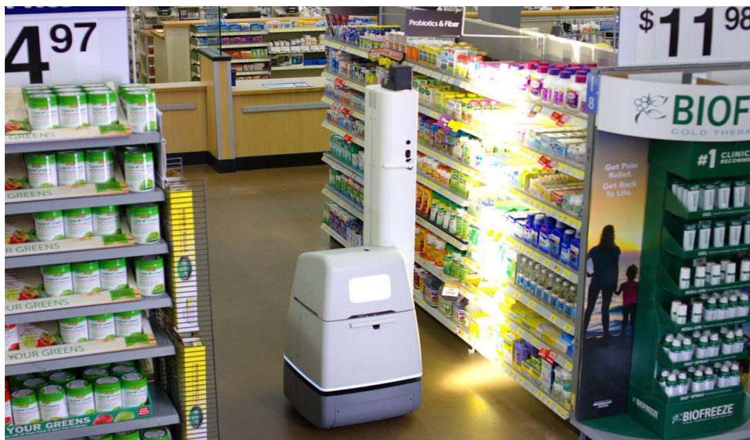
Slika 4 Robot za skeniranje barkodova
