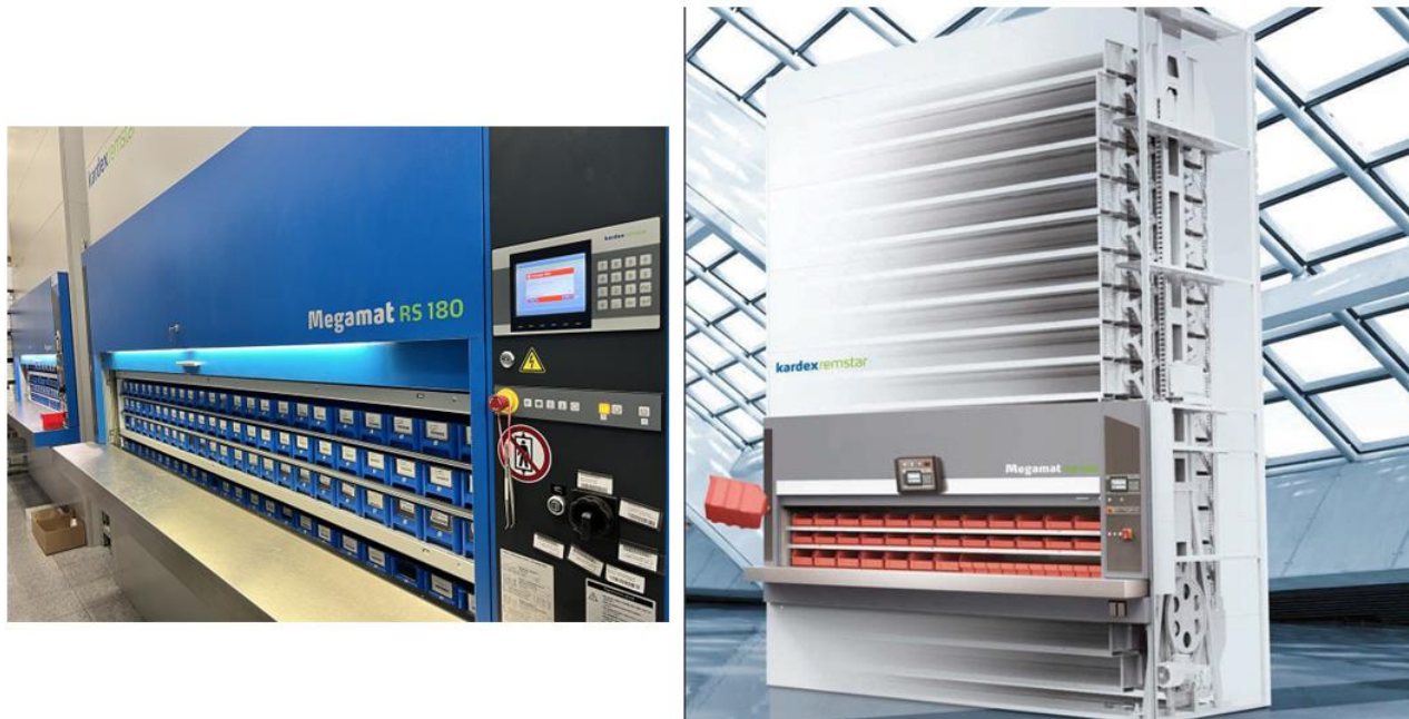
Slika 17. Automatizirani skladišni uređaji – vertikalni karuseli u tvrtki SCL Logistika (Izvor: SCL logistika d.o.o. - Zagreb - Primat Logistika , pristupljeno: 4. srpnja 2023.)
