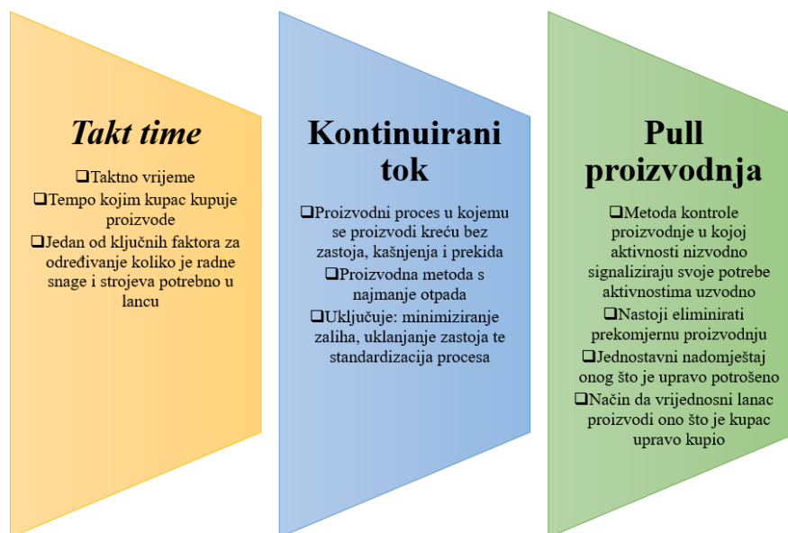
Slika 11. Operativni elementi JIT-a (izrada autora prema Dreckshage, Kerber, 2011; 11)
