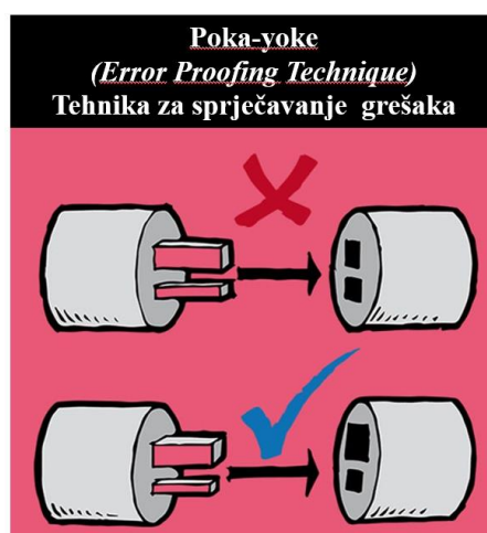
Slika 12. Vizualni prikaz principa Poka-yoke (izrada autora prema Endromena, 2017)
