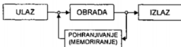
Slika 1 Fizička struktura menadžerskog informacijskog sustava
