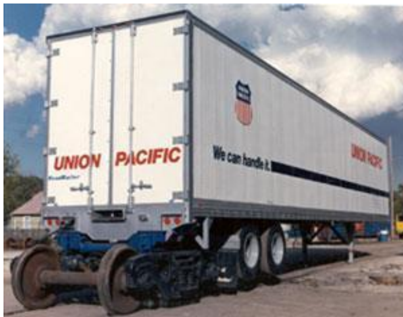
Slika 9: Poluprikolica sa dvoosovinskim željezničkim podvozjem
