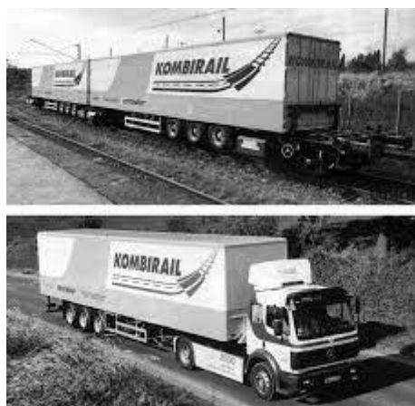
Slika 7: HUCKEPACK tehnologija B
