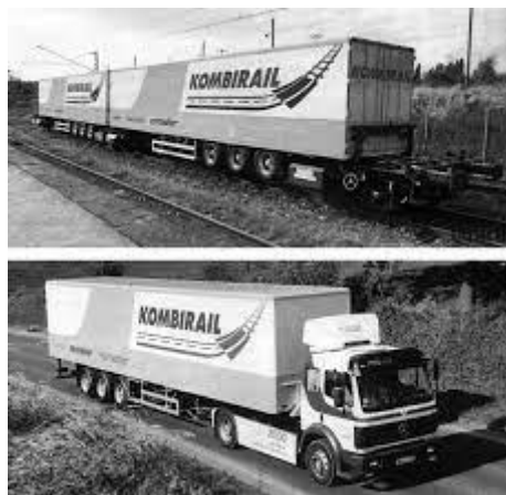
Slika 7: HUCKEPACK tehnologija B
