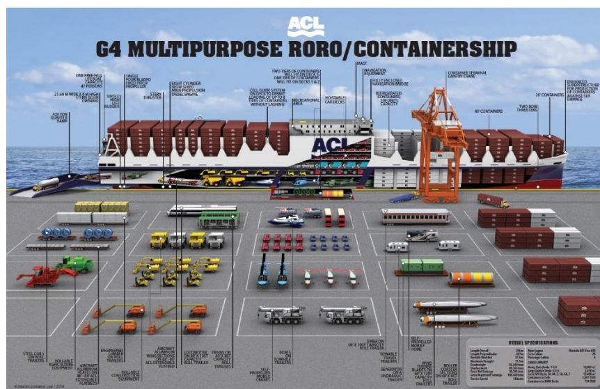
Slika 10: Ro – Ro brod
