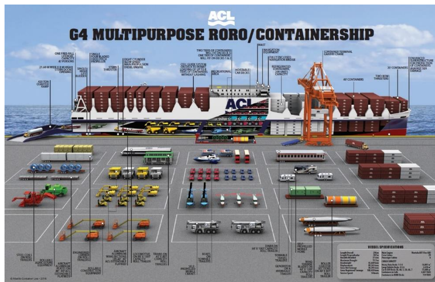
Slika 10: Ro – Ro brod
