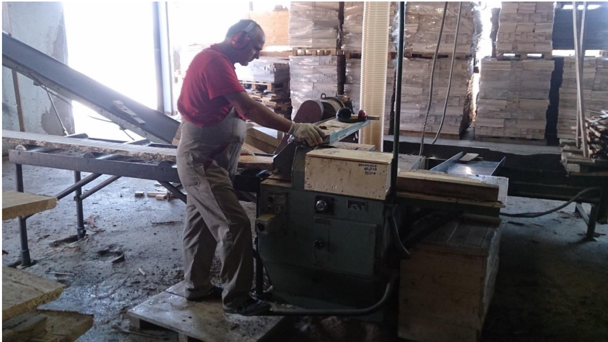
Slika br. 10. Proces brušenja (Izrada autora)
