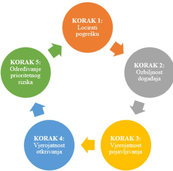
Slika 8 Osnovni princip FMEA metode
