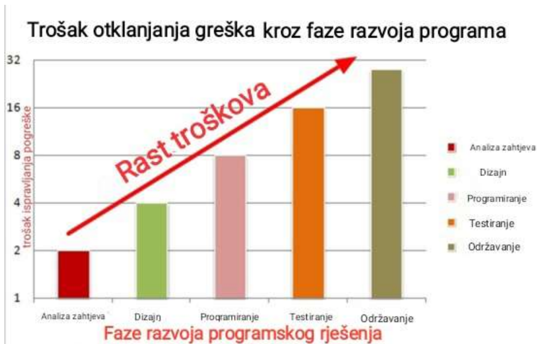
Slika 1. Trošak ispravljanja greške s obzirom na vrijeme detektiranja tijekom životnog ciklusa programskog rješenja
