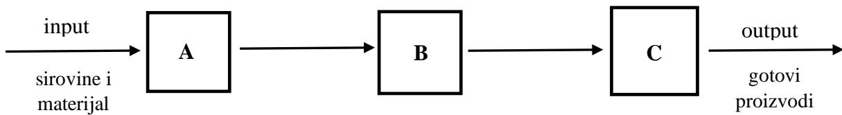
**Slika 5.** Linijski raspored opreme s jednom proizvodnom linijom
