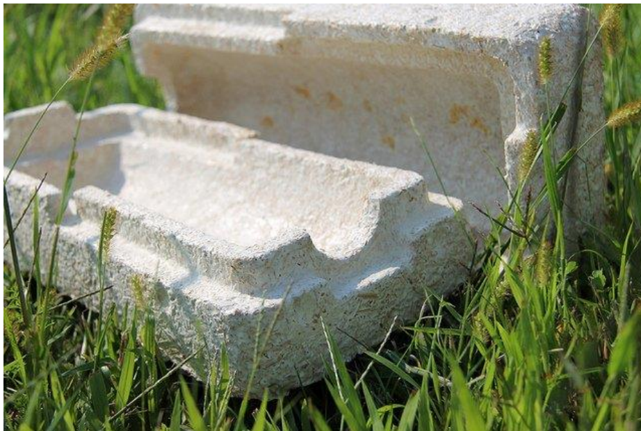
Slika 1 Prikaz ambalaže izrađene od gljiva
