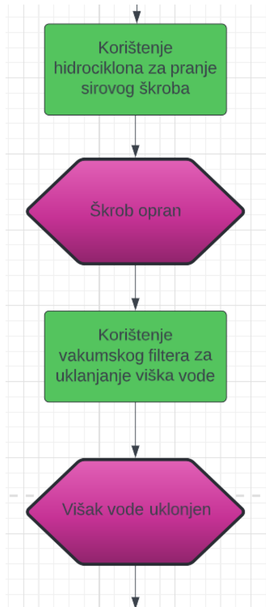
Slika 11 - proces sušenja i uklanjanja viška vode
