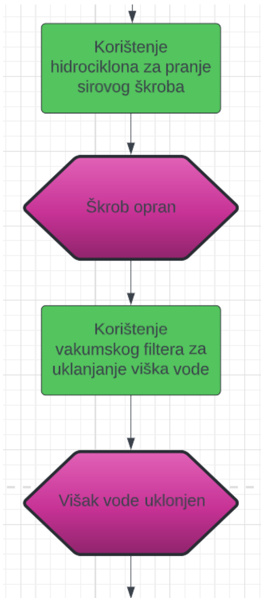
Slika 11 - proces sušenja i uklanjanja viška vode
