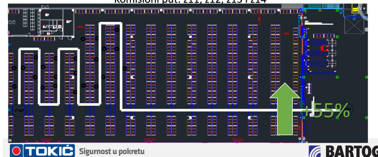
Slika 10. Komisioni put (novi princip – označeno bijelom linijom) Izvor: izrada Sandre Novak, Lean specijalista u tvrtci Tokić
