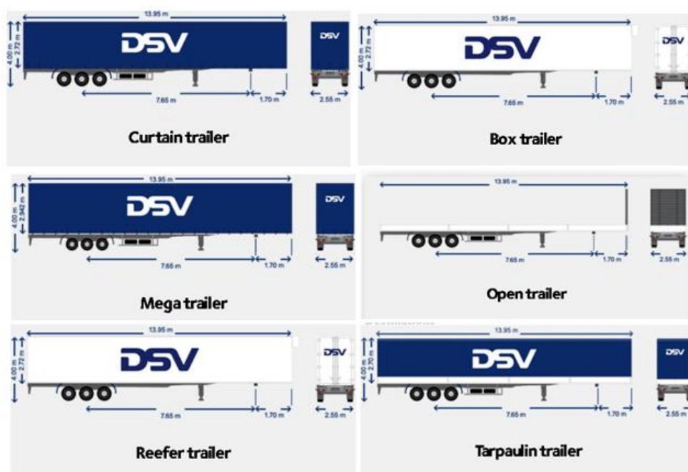
Slika 9: Prikaz vrsti kamionskih prikolica koje tvrtka DSV koristi u cestovnom prijevozu, Izvor: DSV Global Transport and Logistics
