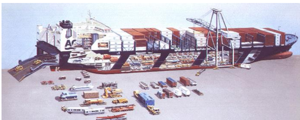
Slika 5: Prikaz RO-RO tehnologije na skici Ro-Ro broda, izvor: Ro/Ro ships, Ventura (2023)
