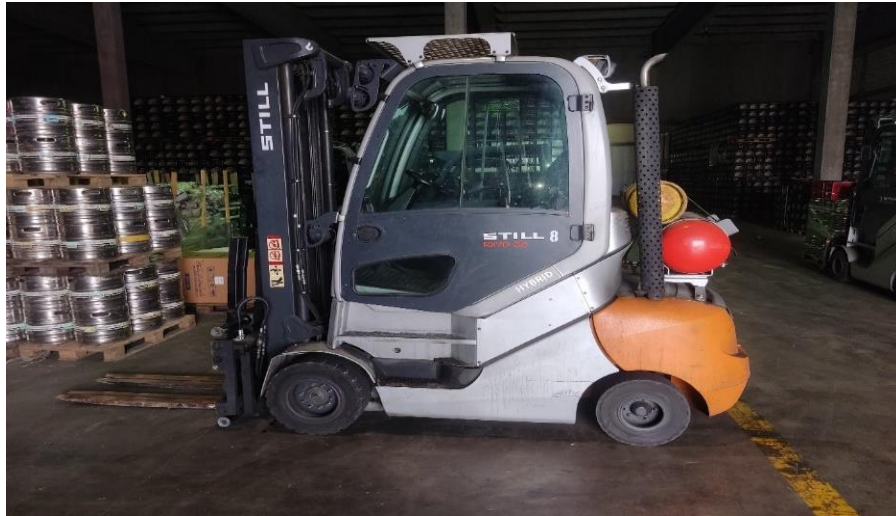
Slika 11. Plinski čeonni viličar u skladištu poduzeća „PRVO HRVATSKO PIVO 1664 d.o.o.“ koji služi za manipulaciju robom na paletama, izvor: autor [fotografirano 08. svibnja 2023.]
