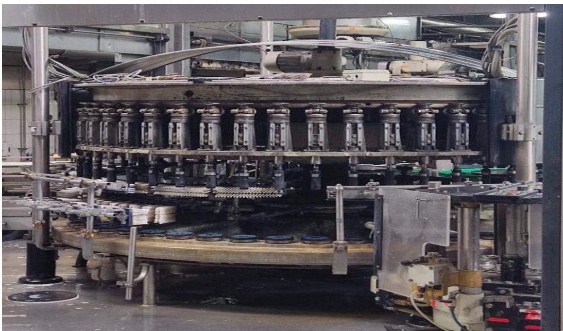
Slika 20. Stroj za punjenje (pakiranje) tekućina u poduzeću „PRVO HRVATSKO PIVO 1664 d.o.o.“, izvor: autor [fotografirano 08. svibnja 2023.]
