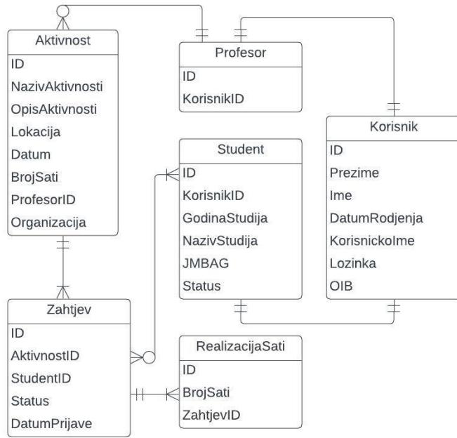
Slika 7. ER dijagram na primjeru sustava za evidenciju volonterskih aktivnosti
