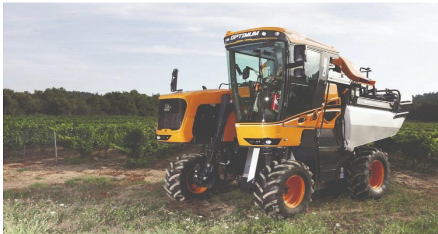
Slika 3. Pellenc samohodni kombajn za berbu grožđa
