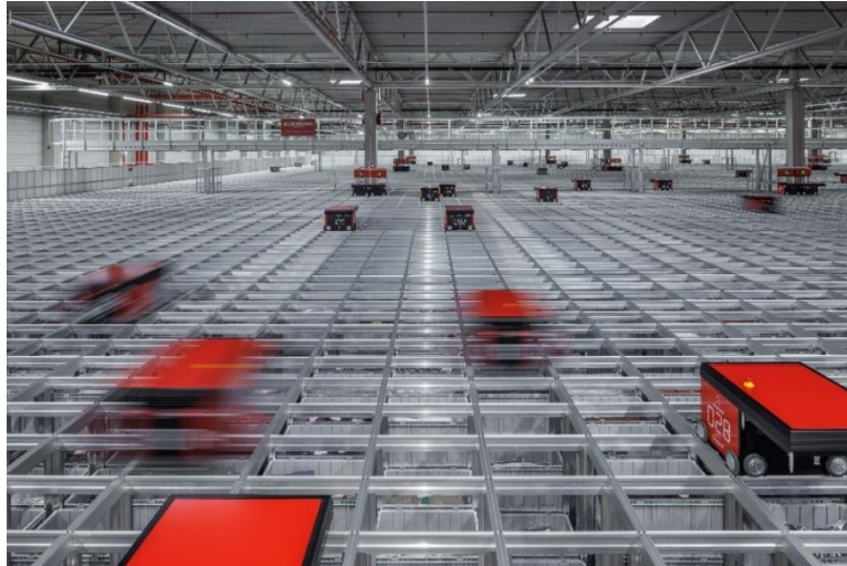
Slika 3. Prikaz skladišta DHL-a implementiranjem sustava AutoStore za pohranu i pronalaženje proizvoda (ASRS)
