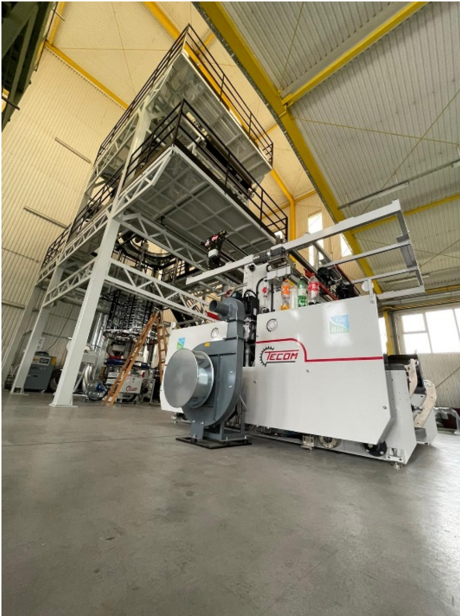
Slika 14. Stroj za proizvodnju PE folije i PE ambalaže
